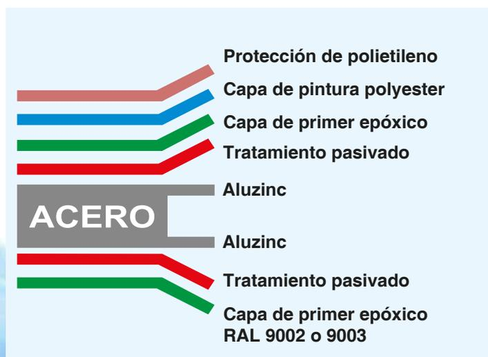
El Aluzinc prepintado está protegido por una película de Polipropileno en la cara superior para evitar daños. Esta película deberá retirarse después de la instalación.
