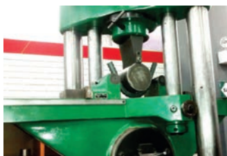
Prueba de Doblado: Doblado a 180° sin presentar fisuras
